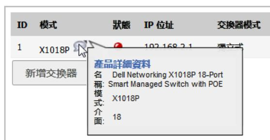
**狀態** 交換器的狀態：綠色的**啟用**圖示表示交換器正常、可用。
