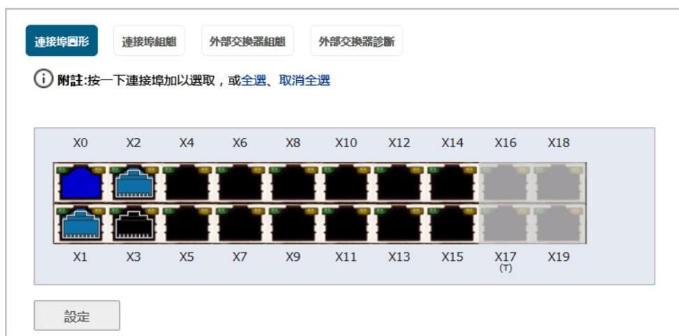
可按一下要分組的連接埠，使用圖形 **PortShield 群組** 介面手動分組多個連接埠。通過群組連接埠，它們可以共用共同的網路子網路以及共同的區域設定。
