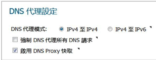
2 在 **DNS 代理模式** 中，選擇用於在安全設備和 DNS 伺服器間傳送/接收 DNS 代理封包的 IP 版本：
