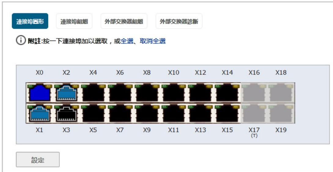
連接埠圖形會顯示安全設備的 PortShield 介面 (連接埠)。大型圖形代表安全設備的介面。介面的顏色代碼反應其設定：
